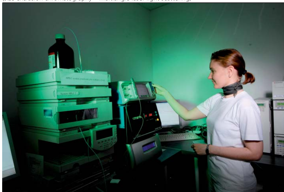
Obrázek 1. Stanovení molekulové hmotnosti hyaluronátu sodného metodou SEC-MALLS (size exclusion chromatography – multiangle laser light scattering)
